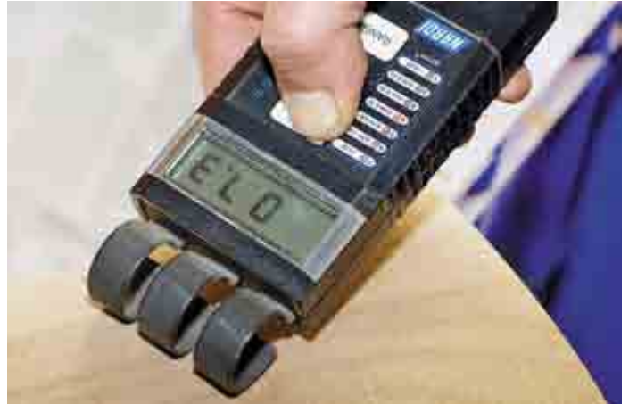
Контроль влажности дерева производится на всех этапах от заготовки до передачи для нанесения покрытия
