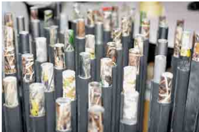
Это не цветные чоки, а технологическая оснастка, окрасившаяся при нанесении изображения на стволы
