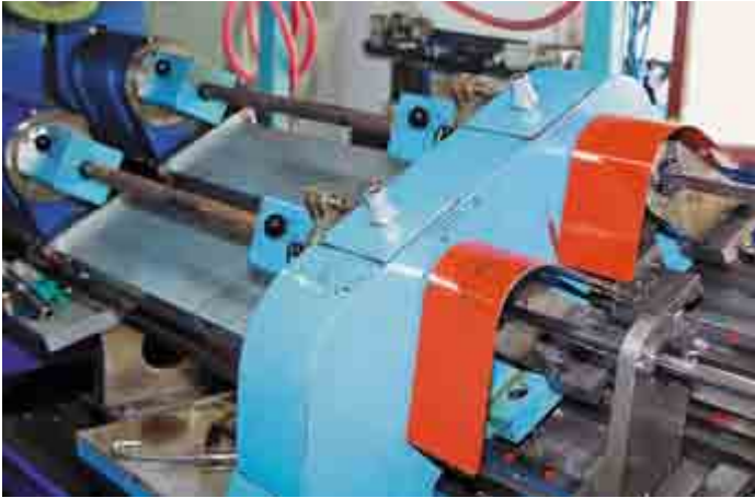
Сверление ствольных заготовок производится парами
