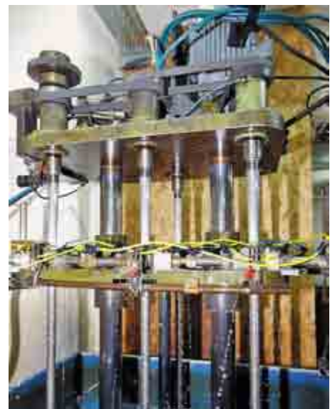
Хонингованию подвергается не только внутренний канал ствола, но его внешняя поверхность (на фото)
