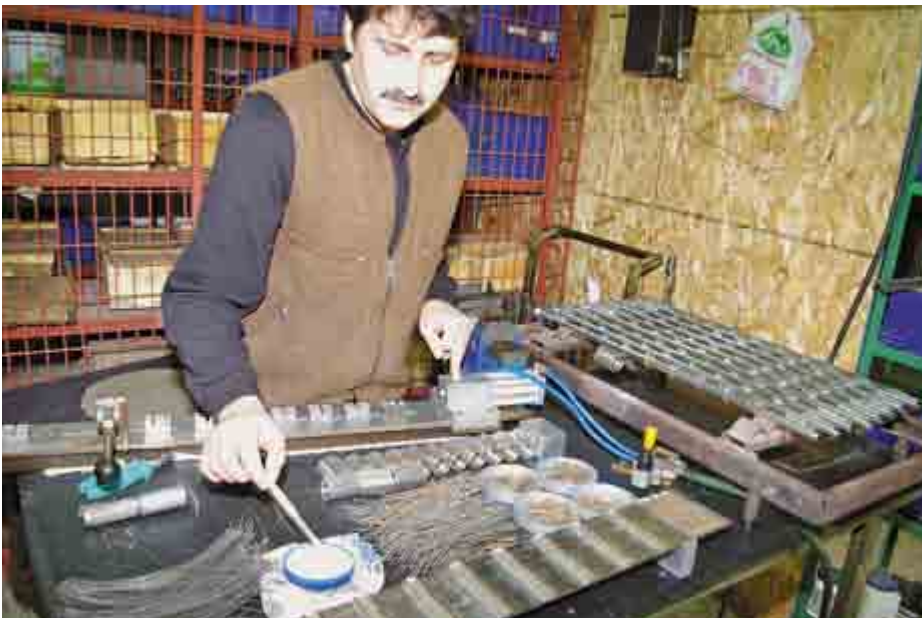
Пайка стволов производится на высокотемпературный серебряный припой
