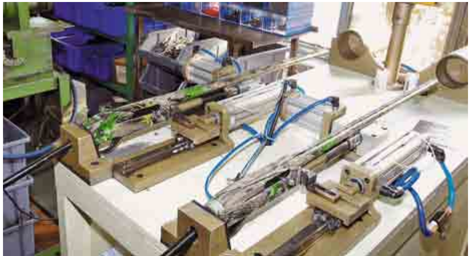
Каждый полуавтомат проходит обкатку полуторатысячами циклов на пневмостенде
